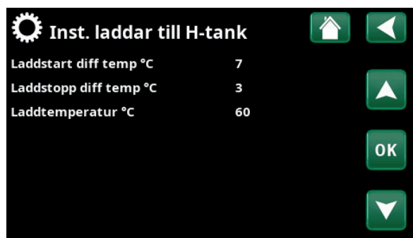
Meny "Avancerat/Inställningar/Solpaneler/Laddar till H-tank".
